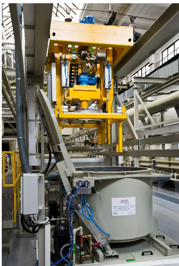
Obr. 2, 3: Speciální zařízení pro následné úpravy hromadně zinkovaných dílů
