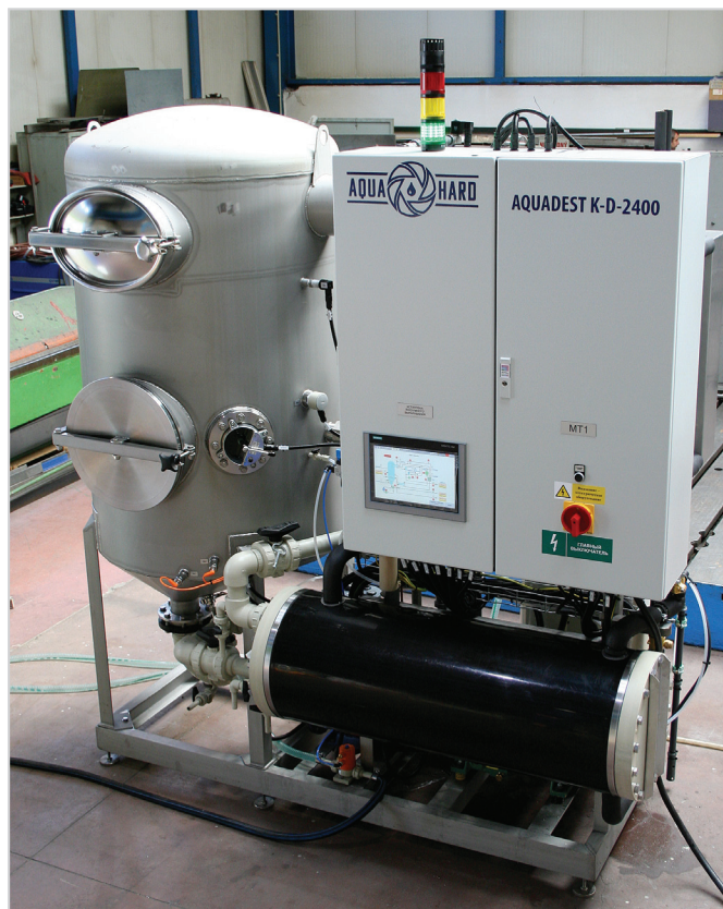
Odparka Aquadest K využívá k chlazení a ohřevu okruh s tepelným čerpadlem.
