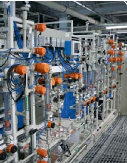
Ionexová cirkulační kolona řízená terminálem MPA-S s odpojovacími deskami.
